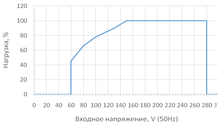
Защита от низкого входного питания U_{вх} , при R_{вых}=100\% , выходная мощность / входное питание
