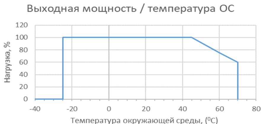
Диапазон рабочей температуры -25 +45С, при  $P_{\text{вых}}$  ИТС 100%. Если температура эксплуатации выше 45С, то и  $P_{\text{вых}}$  ИТС так же должно быть меньше (количество подключаемых СД линеек должно быть меньше).
